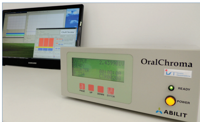
El cromatógrafo calcula la cantidad y las concentraciones de gases sulfurados volátiles.
